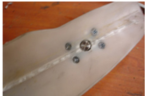
Skruva dit låsmekanismen, sätt dit låsskruv fjäder och mutter.
