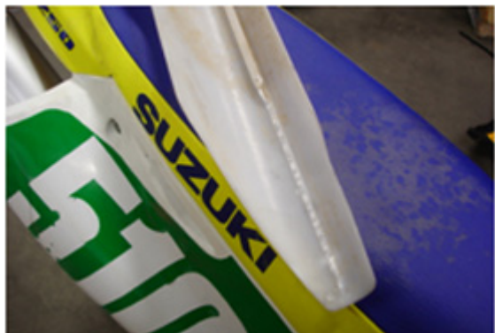
Ta bort förstärkningen till styrningen med t.ex. avbitartång
