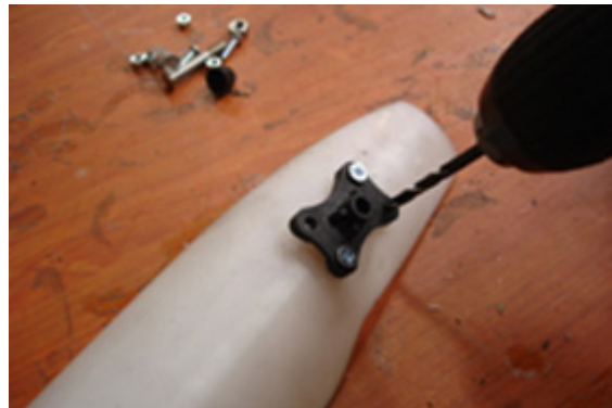
Sätt plastdetaljen för låsmekanism över markeringen och borra de 4 fäst hålen 4.3mm
