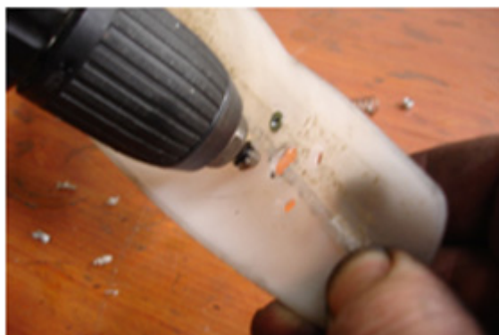
Försänk de 4 fästhålen från insidan med försänkare eller en större borrar.
