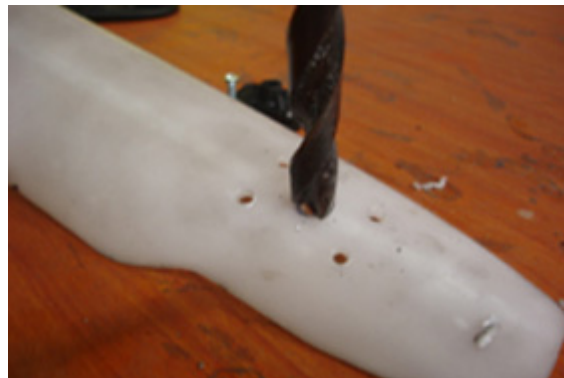
Tag bort låsmekanismen och borra upp mitthålet med 12mm.
